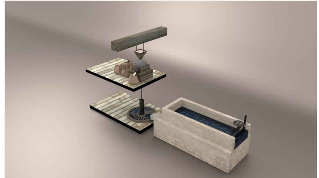
VIRTUALIZACIÓN DEL MOLINO DE SANTA AMELIA. VISTAS DEL MECANISMO DE ROTACIÓN, MOLTURACIÓN Y CANAL DE ENTRADA
